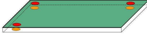
চিত্র 32: সাধারণত, একটি দ্বিমুখী PCB এর উভয় অংশ একে অপরের সাথে সামঞ্জস্যপূর্ণ হতে হবে।
