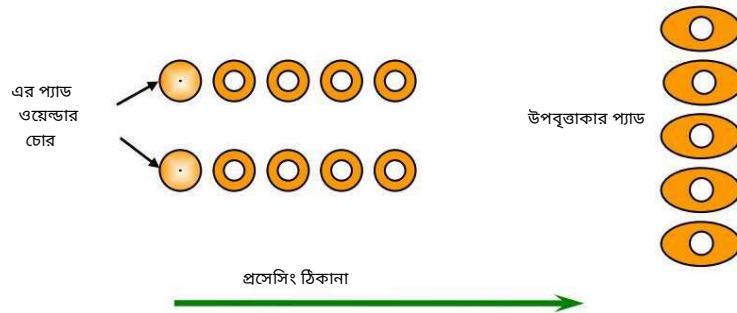
চিত্র 64: ওয়েভ সোল্ডারিং সরঞ্জামের মাধ্যমে বোর্ডের ভ্রমণের দিক সম্পর্কিত সোল্ডার প্যাডের প্রান্তিককরণ।
