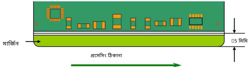
চিত্র 4: একটি PCB-এর মার্জিনের ন্যূনতম মাত্রা।
